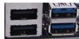
Figura 17.- Conectores USB 2.0 y 3.0
